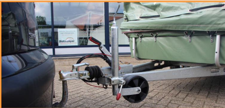
Laat het neuswiel zakken (eerst met de klem aan de zijkant, daarna het neuswiel zelf met de slinger)
