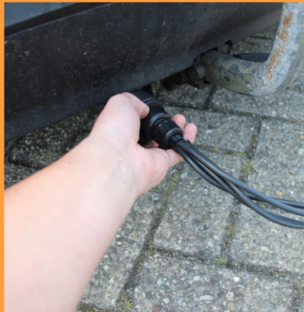
Ontkoppel de elektrastekker en de losbreekkabel
