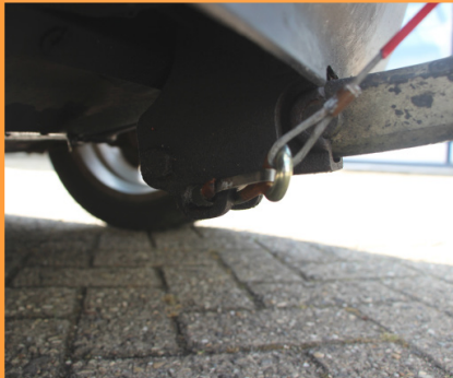
Ontkoppel de elektrastekker en de losbreekkabel
