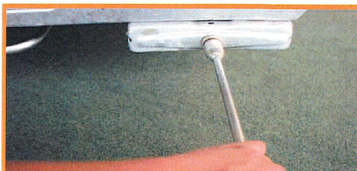
Plaats het neuswiel haaks t.o.v. de rijrichting
