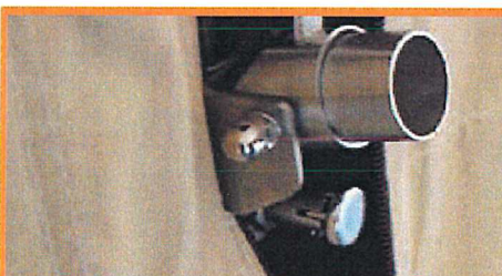
Ontgrendel de klikker op de stomp zodat deze naar beneden schuift en richt hem naar buiten
