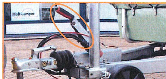
Zet eventueel de tenttrailer op de handrem om weggrollen tijdens het afkoppelen te voorkomen
