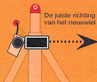
Plaats het neuswiel haaks t.o.v. de rijrichting
